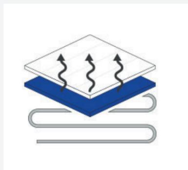
Nuestras bases son aptas para el uso de losa radiante<sup>7</sup>, ya que proporcionan el aislamiento térmico necesario para que la calefacción resulte eficaz.
