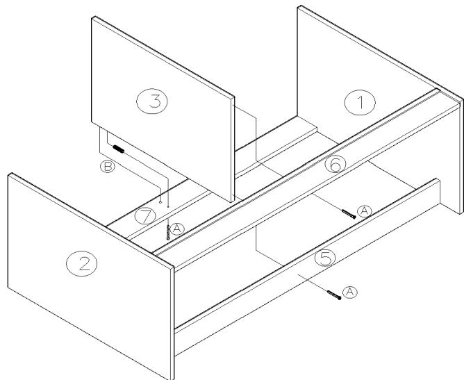
6° PONER DE PIE LA ESTRUCTURA Y UBICAR LA CUBIERTA 4 SOBRE LOS COSTADOS DERECHO 1, IZQUIERDO 2 Y INTERNO 3 CON TARUGOS B Y ENSAMBLAR AJUSTANDO FIRMEMENTE EL MECANISMO DE MINIFIX C. (VEA DIAGRAMA 4: DETALLE DE MONTAJE MINIFIX).
