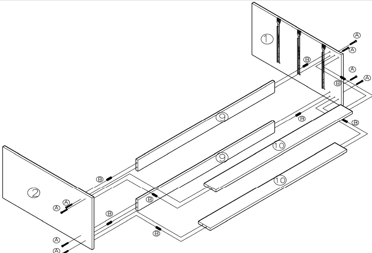
1º COMENZAR CON EL ARMADO DE LA COMODA APOYANDO EL COSTADO DERECHO **(1)** Y COSTADO IZQUIERDO **(2)** DE FORMA HORIZONTAL (CON EL CANTO ENCHAPADO HACIA ARRIBA) UNIR **(A)** BARRAS PISO **(9)** Y A ZOCALOS **(10)** CON TARUGO **(B)** COMO GUIA Y SOBERBIO **(A)** PARA FIJAR.
