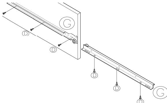
1º UBIQUE LA PARTE DEL RIEL (CON FORMA DE U) FRENTE A LOS PUNTOS DE GUIA EN LOS LATERALES Y FIJELOS FIRMEMENTE UTILIZANDO SPAX (D) PARA RIELES.
