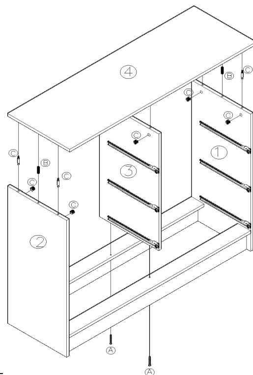
**3º** FIJAR TRASERA ⑪ A LA PARTE POSTERIOR DEL MUEBLE CON CLAVOS ⑫, LUEGO, MONTAR LOS CAJONES YA ENSAMBLADOS SOBRE LOS RIELES ⑬ PREVIAMENTE FIJADOS A COSTADO DERECHO ① IZQUIERDO ② INTERNO ③ (VEA DIAGRAMA 3: DETALLE DE ARMADO DE CAJÓN Y DIAGRAMA 1: DETALLE DE INSTALACIÓN DE RIELES PAG.4).
