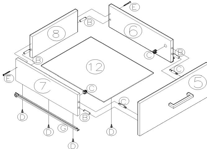
1º UNA EL FRENTE DE CAJÓN (5) A COSTADO DE CAJÓN DERECHO (6) E IZQUIERDO (7) POR MEDIO DE DOS TARUGOS (B) Y DOS MINIFIX (C) (VER DIAGRAMA 2 : DETALLE DE MONTAJE DE MINIFIX).
