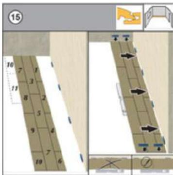
Las tablas se colocan según la numeración de la imagen. (Recorte la primera fila si es necesario, como se describe en la Figura 10.) En esta secuencia, las primeras 3 filas se colocan en la habitación. Esta forma de colocación asegura que las filas estén conectadas en línea recta. A continuación, las filas preinstaladas se empujan contra la pared. La distancia entre la pared y las filas de paneles se fija con cuñas espaciadoras. Después de eso, la colocación se puede continuar fila por fila.
