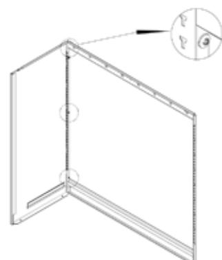
Utilice los tornillos autorroscantes para conectar el panel derecho a la parte posterior.
