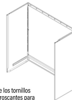
Utilice los tornillos autorroscantes para conectar el marco frontal a la parte posterior.
