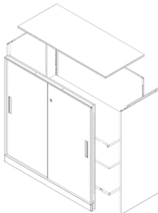
Utilice los tornillos autorroscantes para conectar el panel izquierdo a la parte posterior.
