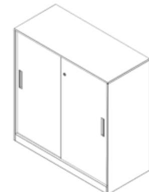
Conecte la parte superior e inferior al gabinete usando los tornillos autorroscantes. Instale las patas ajustables en la placa base.
