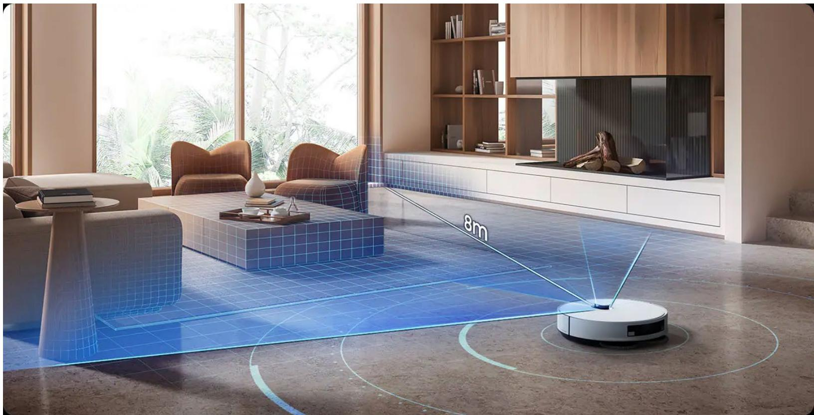
\*Esta función puede verse afectada por el tamaño y la forma de un objeto, o las condiciones ambientales. \*\* Basado en pruebas internas en comparación con el modelo Jet Bot VR8000 con un sensor LiDAR convencional. Escanea 360° a una distancia que oscila entre 5 cm y 8 m.
