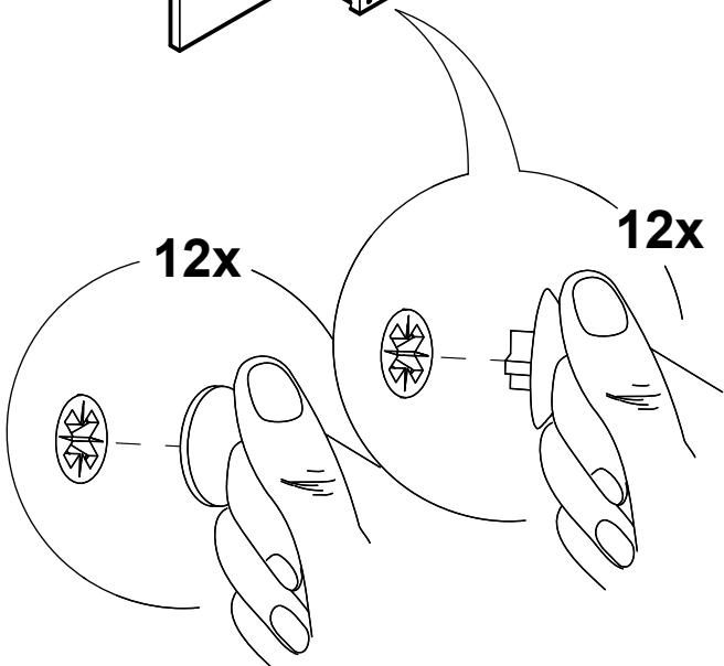
Fije el mueble al muro, perforando la barra trasera y utilizando los herrajes indicados, Según el tipo de mueble que usted tiene.
