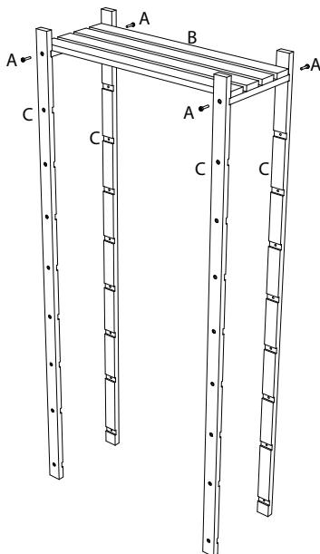
Paso 1: Alinear el laminado con la ranura de madera cuadrada y fijar los tornillos hacia adentro y hacia abajo en el sentido de las agujas del reloj sin apretar especialmente.
