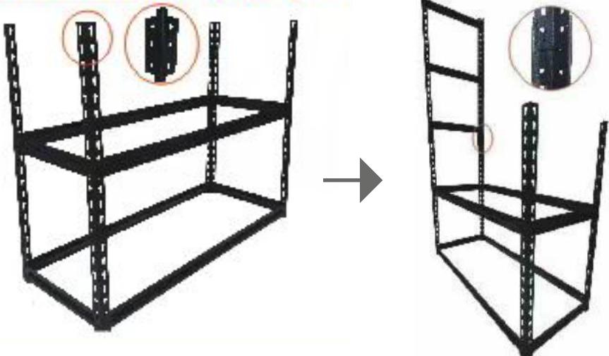
Instale el conector y coloque la parte superior del marco vertical en el conector, luego coloque la viga corta en el orificio para conectar la parte inferior del marco vertical con la parte superior del marco vertical.
