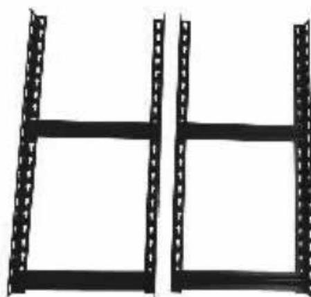
Ensamble una viga corta en otro marco como en el primer paso. Coloque la viga corta a la misma altura que el primer marco vertical.
