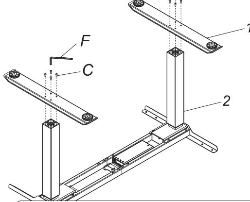
Coloque los pedestales (1) en la parte inferior de la columna de elevación (2). Fije los pies con tornillos (C) con llave Allen (F).
