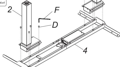
Inserte las columnas de elevación (2) en los extremos de la viga de soporte (4). Fije las columnas de elevación usando tornillos (D) con la llave Allen (F).
