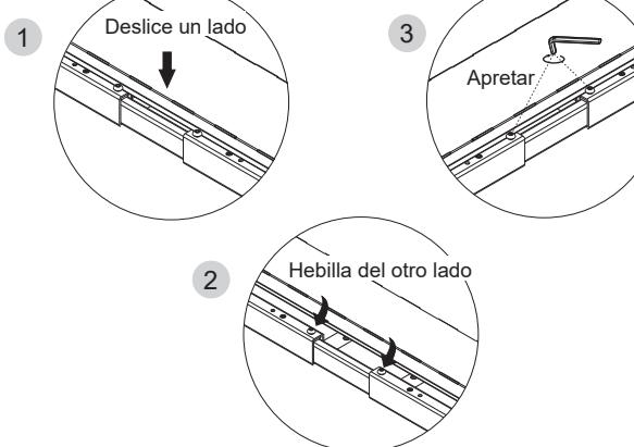
En primer lugar, gire los tornillos (B) de forma incompleta en la viga de soporte (4) con llave Allen (F), lo que significa que no los apriete. A continuación, deslice uno lado de la bandeja de administración de cables (3) en los tornillos (B), luego el otro lado. Finalmente, apriete los tornillos (B) con la llave Allen (F).
