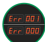
Protección sobre y bajo voltaje (Err 001 / Err 000)
