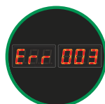
Protección sobre temperatura (Err 003)
