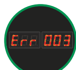
Protección sobre temperatura (Err 003)
