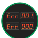
Protección sobre y bajo voltaje (Err 001 / Err 000)
